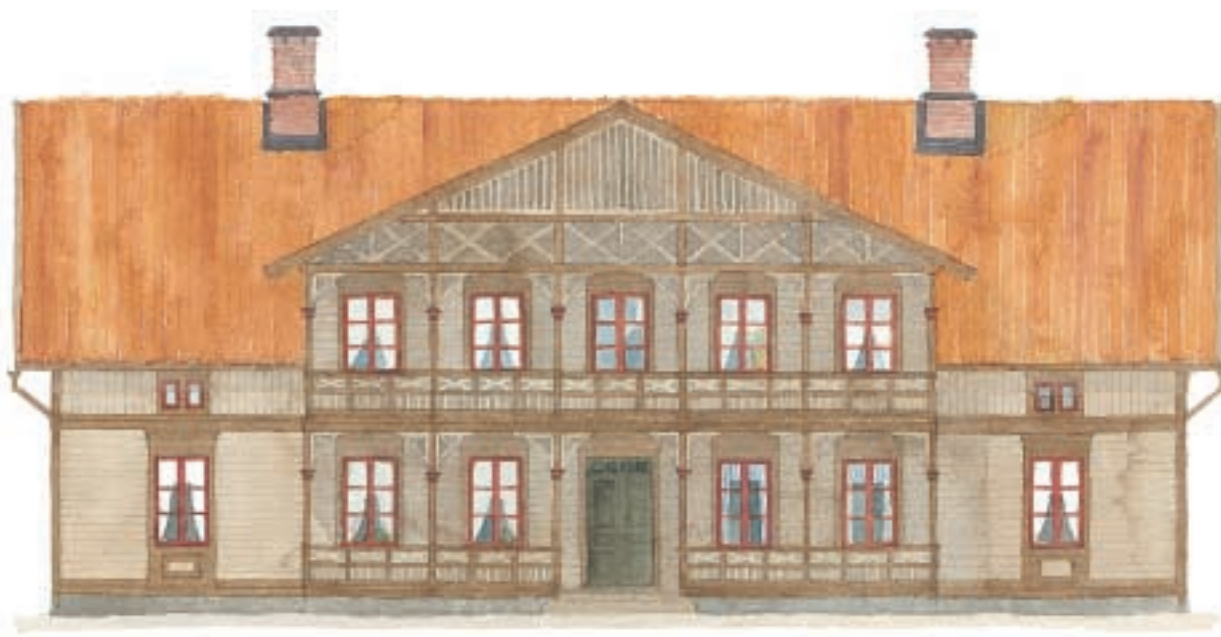
Färgsättning från 1890-talet. Under 1800-talets andra hälft blev färgskalan dovre och man började använda bruna, gulgrå och gröna kulörer. Fönstren målades ofta i rött, brunt eller grönt.
